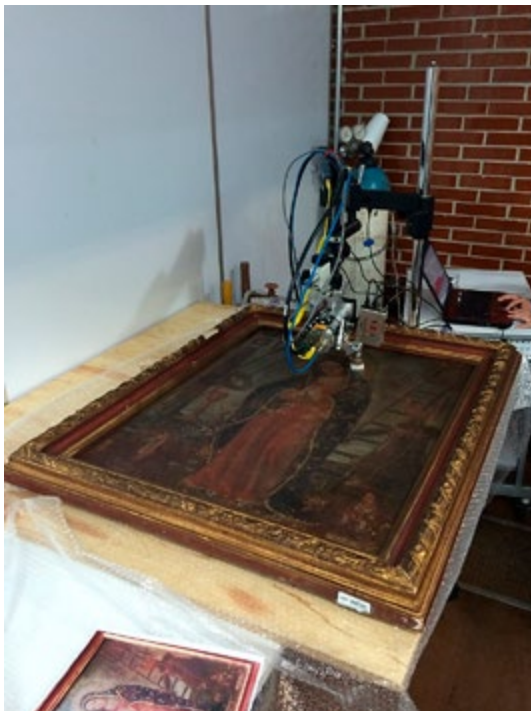
Figura 1. Examen de la pintura mediante el equipo de XRF SANDRA.
